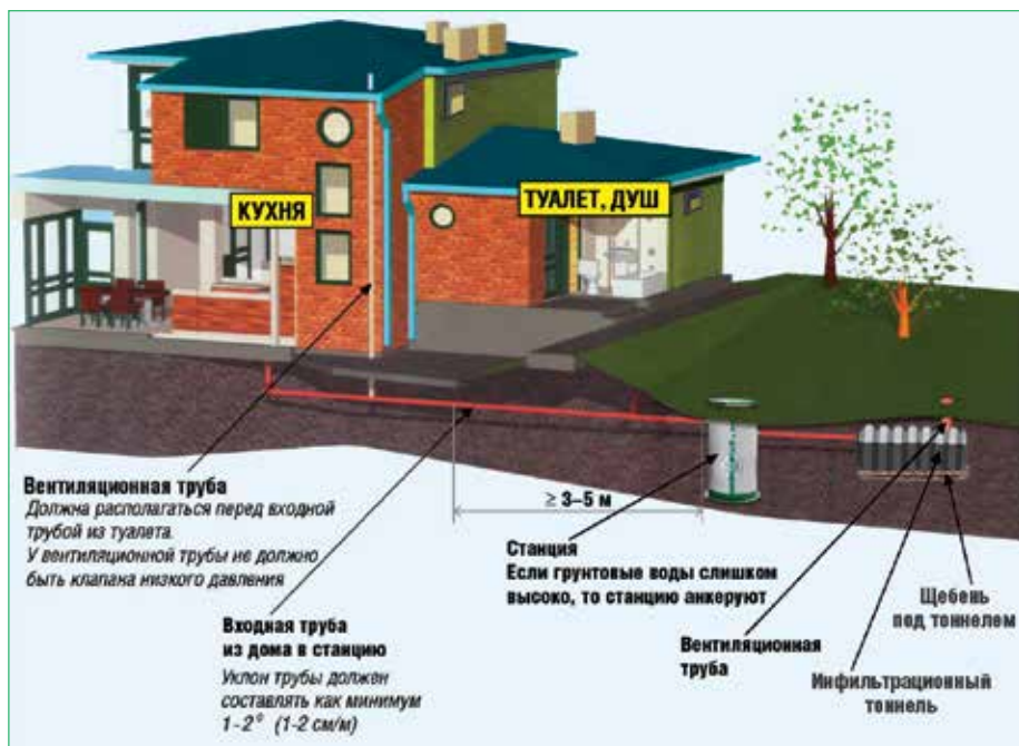
Рис. 2 Схема установки станции FloTenk-BioPurit
