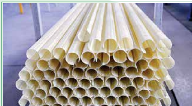
С-образный профиль для использования в составе зондов глубокого бурения
