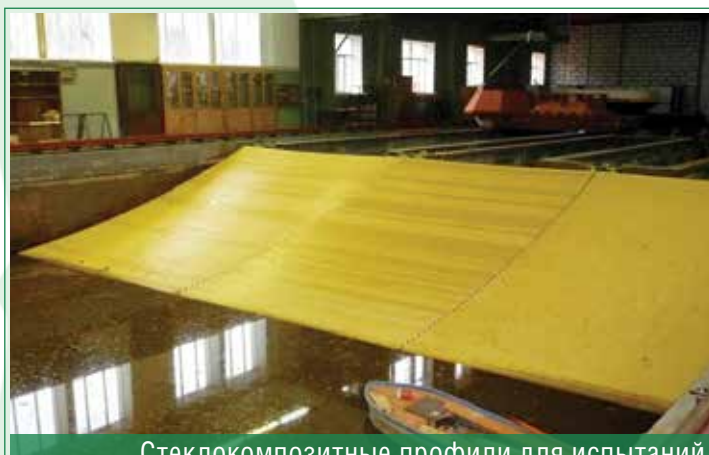
Стеклокомпозитные профили для испытаний в ЦИИ Крылова
